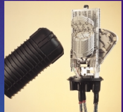
FIST-GCO2 Универсальная муфта для оптического кабеля с функцией выделения волокон по оптической цепи (оптическому элементу) или их транзиту
